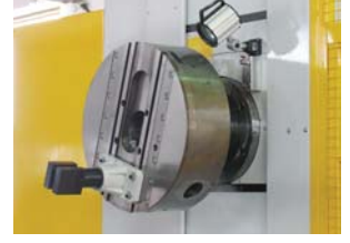
W-ekseni ile sürülen alın işleme kafası
