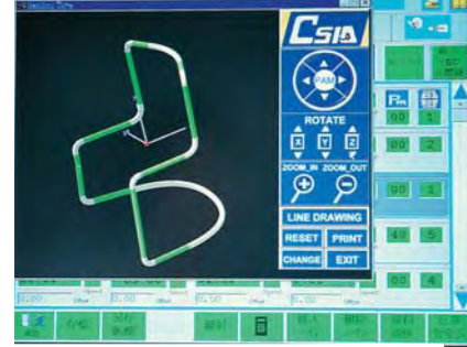
Parça bazında resim kontrolü ve simulasyon kabiliyeti. Büküm öncesi makinede yapılabiliğini kontrol edebilirsiniz
